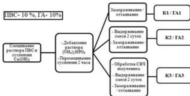
Рис 1. Схема получения композиционных материалов ГА-ПВС
