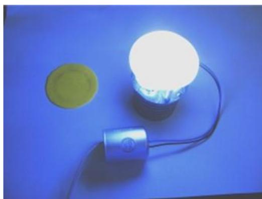
Рис. 2. Макет светодиодного светильника с полимерно-кристаллическим светопреобразователем
